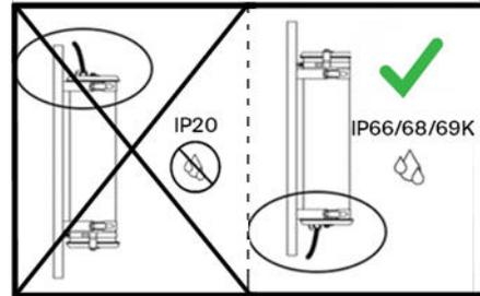
Vérifier impérativement la correcte fermeture des organes d'étanchéité du produit, y compris pour les produits livrés précâblés.
