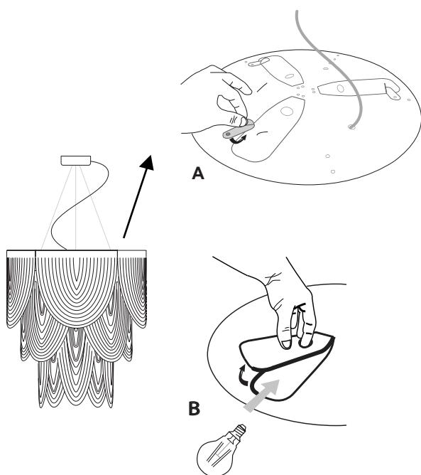
Per cambiare le lampadine usare le aperture poste sulla parte superiore del diffusore. Ruotare il fermo sportello per accedere al portalamppade (figura B)
