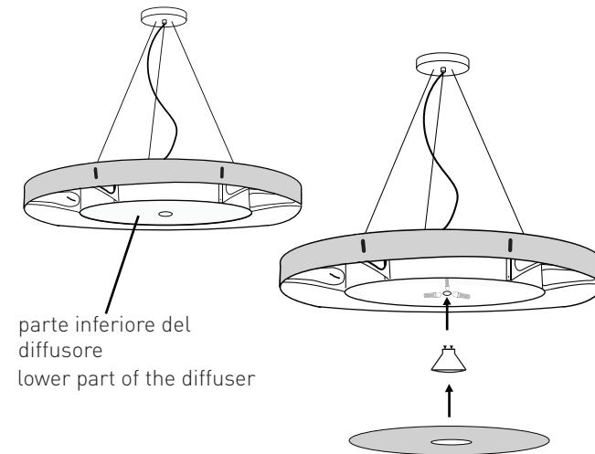
Per inserire lo spot svitare la parte inferiore del diffusore e avitarlo al portalampada.
