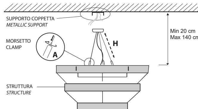
Inserire i due cavi di acciaio non collegati ai morsetti svitando e premendo il grano [A]. Regolare l'altezza dal soffitto [H] facendo scorrere i tre cavi, riavvitare il fermo, controllare che le tre lunghezze siano le stesse [H] e tagliare il cavo in eccesso.
