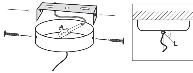
Riporre la scatolina nella coppetta, avvitare la coppetta al supporto tramite viti nei fori laterali come indicato in figura e serrare il grano (L).
