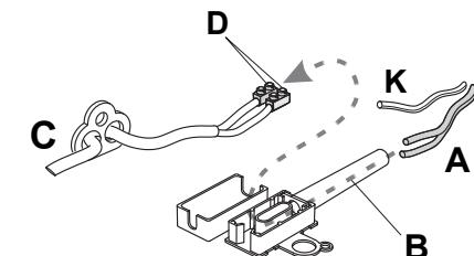
Inserire i fili elettrici [A] provenienti dal soffitto all'interno del tubicino [B] e connetterli ai fili elettrici della lampada [C] mediante i morsetti [D]. Non connettere il cavo giallo-verde (K).
