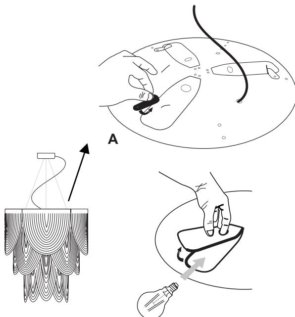
Per inserire le lampadine usare le aperture poste sulla parte superiore del diffusore. Ruotare il fermo (figura A) e, aiutandosi con i fori predisposti sollevare lo sportello per accedere al portalampade (figura B)
