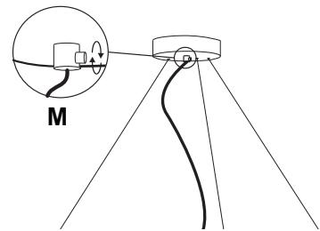
Regolare la lunghezza (H2) del cavo elettrico e tagliare il cavo in eccesso prima di collegarli ai cavi provenienti dal soffitto. Per far scorrere il cavo allentare il grano del serracavo [M] per poi riserrarlo.
