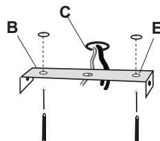
Forare il soffitto in 2 punti secondo le asole [E] predisposte e inserirvi i tasselli. Fissare al soffitto il supporto [B] per la coppetta cromata con le viti. Attenzione a non bloccare i cavi provenienti dal soffitto [C].
