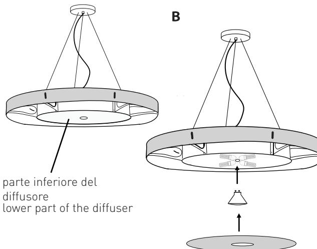
Per cambiare lo spot smontare il primo strato di braccia. (fig A). Svitare la parte inferiore del diffusore e avvitare la lampadina portalamppada (fig B). Richiudere il diffusore e rimontare le braccia.
